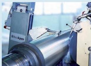
Merací a inšpekčný systém HCC KPM pracuje nepretržite. Vysoko presný inkrementálny merací prístroj s dvoma dotykovými meracími sondami prechádza pozdĺž otočného valca a určuje jeho aktuálny tvar a priemer, ako aj akékoľvek poškodenie valca.
