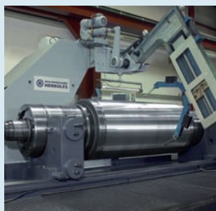
Hrotová brúška Herkules WS 600. Valce určené na obrábanie môžu mať hmotnosť až 400 ton a dĺžku až 10 metrov.
