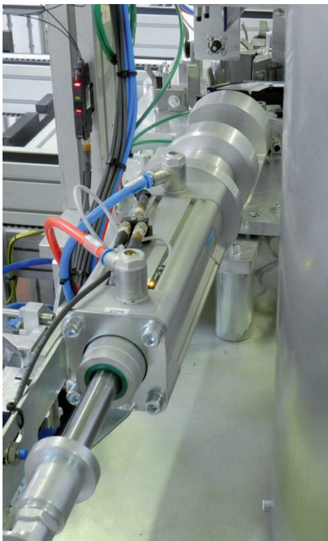
Zatlačenie pružiny do dutiny kľučky má na starosti pneumatický valec Festo
