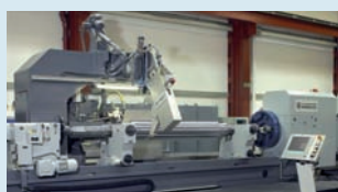
Herkules WS 450 Monolit™ na brúsenie a prekladanie valcov
