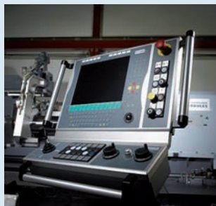
Vstupy do stroja sa realizujú pomocou ovládacieho panela, ktorý bol navrhnutý v spolupráci s Herkulesom v súlade s ich špeciálnymi požiadavkami.
