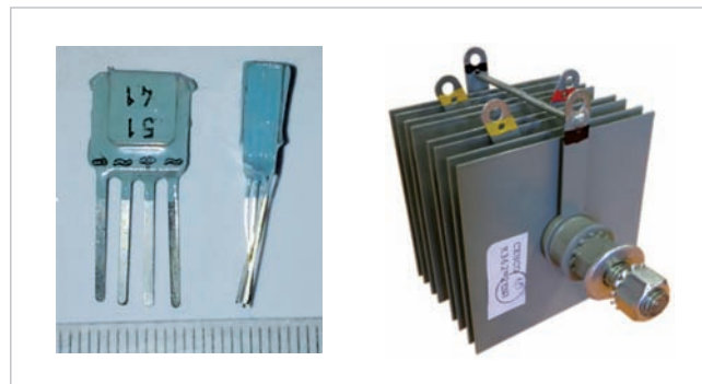
Selénový miniatúrny usmerňovač (vľavo) a selénový platňový usmerňovač (vpravo)
