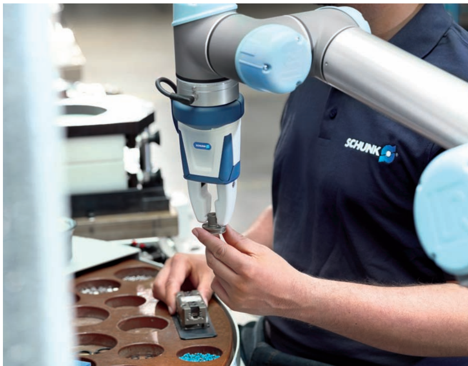
Certifikovaný uchopovač SCHUNK EGP-C Co-act na kolaboratívne operácie uľahčuje kolaboratívne scenáre pri montáži malých komponentov.
