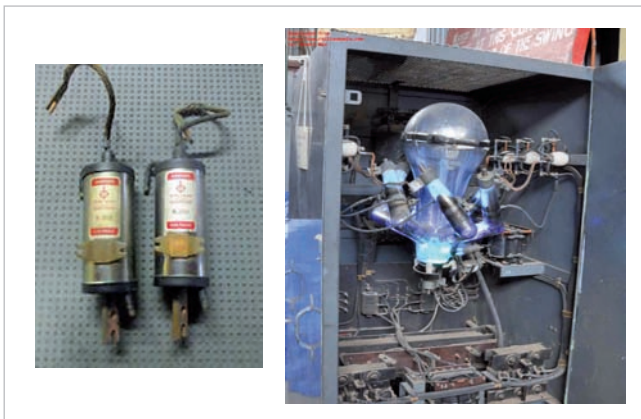
Ignitrón 1 500 V/56 A (vľavo) a ortuťový usmerňovač 600 V/200 A (vpravo)
