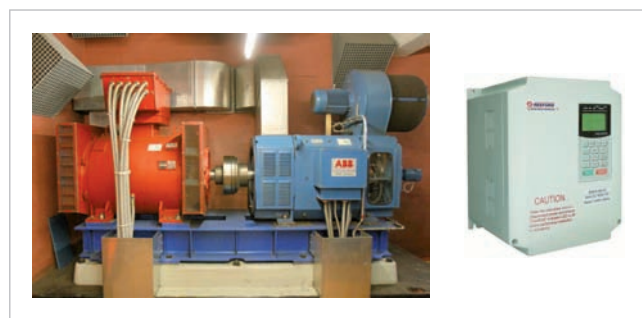
Motor-generátor Ward-Leonardovej skupiny (vľavo) a menič napätia a frekvencie, tzv. frekvenčný menič (vpravo)
