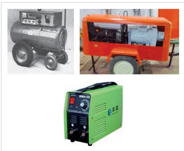
Zdroje zväracieho prúdu – triodyn = 220 A/29 V poháňaný elektromotorom (vľavo), triodyn = 315 A/32 V poháňaný diesielovým motorom (v strede) a elektronický menič (vpravo)
